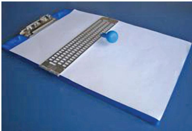
Figura 8 - Prancheta de plástico com uma reglete de metal e um punção azul.
